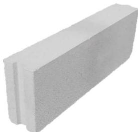
Thermostone ploča TS-P 10/400 je kvadar s utorom i perom a upotrebljava se za izgradnju nenosivih pregradnih zidova. Prvi red ploča se postavlja na cementni mort, dok se ostali redovi zidaju pomoću tankoslojnog morta za porasti beton.
