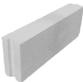
Thermostone blok TS-B 15/400 je kvadar s utorom i perom a upotrebljava se za izgradnju nenosivih pregradnih zidova. Prvi sloj se obavezno nanosi na sloj cementnog morta, a pri zidanju se koristi tankoslojni mort za porasti beton.
