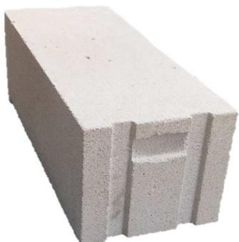
Thermostone termo blok TS-T 40/450 ima izrazito dobra termička svojstva pa je prikladan za zidanje vanjskih zidova. Ima izvrsnu toplinsku izolaciju i djeluje kao masivna i stabilna konstrukcija. Prvi red se obavezno postavlja na sloj cementnog morta, a dalje se zidanje provodi tankoslojnim mortom za porasti beton.
