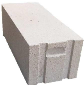
Thermostone termo blok TS-T 30/400 ima izrazito dobra termička svojstva pa je prikladan za zidanje vanjskih zidova. Ima izvrsnu toplinsku izolaciju i djeluje kao masivna i stabilna konstrukcija. Prvi red se obavezno postavlja na sloj cementnog morta, a dalje se zidanje provodi tankoslojnim mortom za porasti beton.
