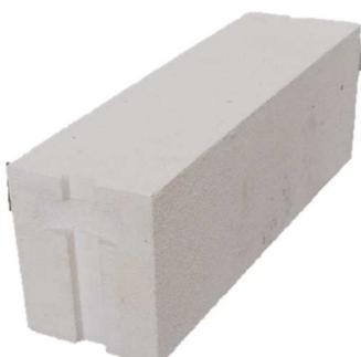
Thermostone blok TS-B 17/400 upotrebljava se za gradnju unutarnjih nenosivih pregradnih zidova. Prvi red se obavezno nanosi na sloj cementnog morta, a pri zidanju se koristi tankoslojni mort za porasti beton.
