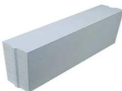
Thermostone blok TS-B1 15/450 je kvadar s utorom i perom a upotrebljava se za izgradnju nenosivih pregradnih zidova. Prvi red se obavezno nanosi na sloj cementnog morta, a pri zidanju se koristi tankoslojni mort za porasti beton.
