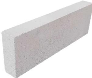
Thermostone ploča TS-P 5/400 ima veliku površinu i malu debjinu i koristi se za završne radove interijera građevina. Idealna je za oblaganje tuš kabina i kada, a primjenjuje se i kod zatvaranja instalacijskih kanala.
