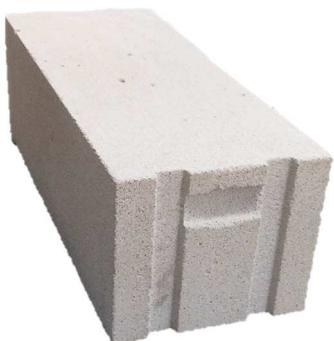
Thermostone termo blok TS-T 40/400 ima izrazito dobra termička svojstva pa je prikladan za zidanje vanjskih zidova. Ima izvrsnu toplinsku izolaciju i djeluje kao masivna i stabilna konstrukcija. Prvi red se obavezno postavlja na sloj cementnog morta, a dalje se zidanje provodi tankoslojnim mortom za porasti beton.
