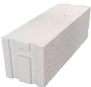
Thermostone blok TS-B 24/450 upotrebljava se za zidanje ispunskih vanjskih zidova, te kao unutarnji pregradni zid većeg protupožarnog ili statičkog zahtjeva. Prvi red se obavezno nanosi na sloj cementnog morta, a pri zidanju se koristi tankoslojni mort za porasti beton.
