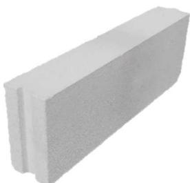
Thermostone ploča TS-P 10/450 je kvadar s utorom i perom a upotrebljava se za izgradnju nenosivih pregradnih zidova. Prvi red ploča se postavlja na cementni mort, dok se ostali redovi zidaju pomoću tankoslojnog morta za porasti beton.
