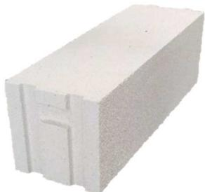
Thermostone blok TS-B 20/450 upotrebljava se za gradnju unutarnjih nenosivih pregradnih zidova, te kao unutarnji pregradni zid većeg protupožarog ili statičkog zahtjeva. Prvi red se obavezno nanosi na sloj cementnog morta, a pri zidanju se koristi tankoslojni mort za porasti beton.
