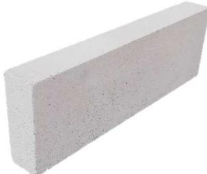
Thermostone ploča TS-P 7,5/450 ima veliku površinu i malu debljinu i koristi se za završne radove interijera građevina. Idealna je za oblaganje tuš kabina i kada, a primjenjuje se i kod zatvaranja instalacijskih kanala i izgradnje kamina. Prvi red ploča se postavlja na cementni mort, dok se ostali redovi zidaju pomoću tankoslojnog morta koji se nanosi na fuge. Ploču je prije nanošenja morta potrebno očistiti od prašine.
