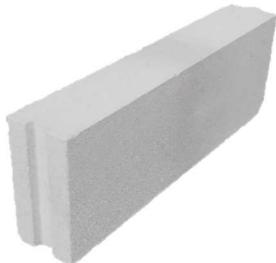
Thermostone blok TS-B 12/400 je kvadar s utorom i perom a upotrebljava se za izgradnju nenosivih pregradnih zidova. Prvi sloj se obavezno nanosi na sloj cementnog morta a pri zidanju se koristi tankoslojni mort za porasti beton.
